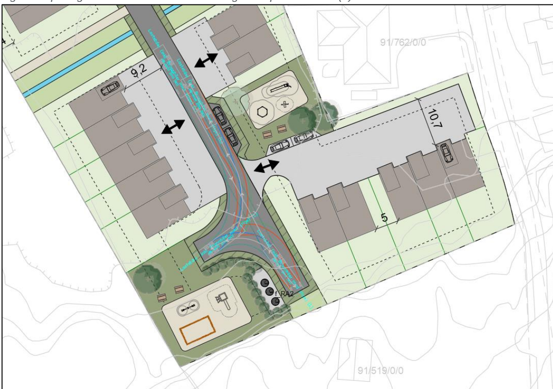
Figur 3: Spøringskurve for lastebil (L) ved RA2 og vendehammer.
