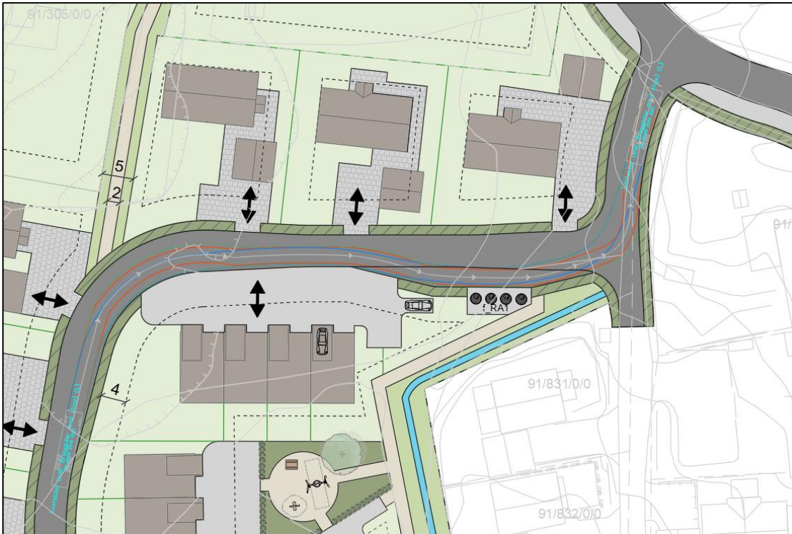
Figur 2: Spøringskurve for lastebil ved RA1 og ut av planområdet (L)
