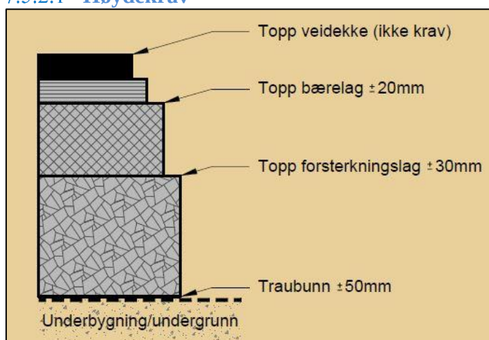
Figur 7.6: Toleransekrav i overbygningen
