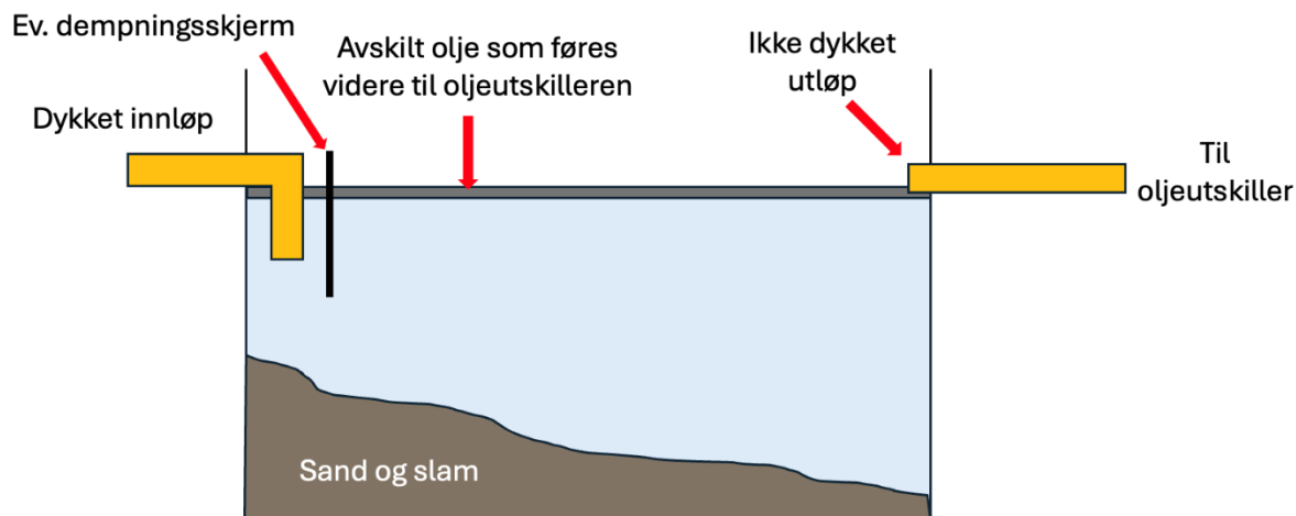
Figur 5. Skjematisk oppbygging av sandfanget
